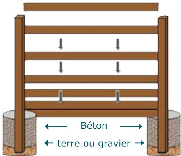
Schéma d'installation des poteaux dans des anneaux béton. Couler le béton autour du poteau de façon à ce que la base du poteau soit en contact avec la terre ou idéalement sur un lit de gravier.
